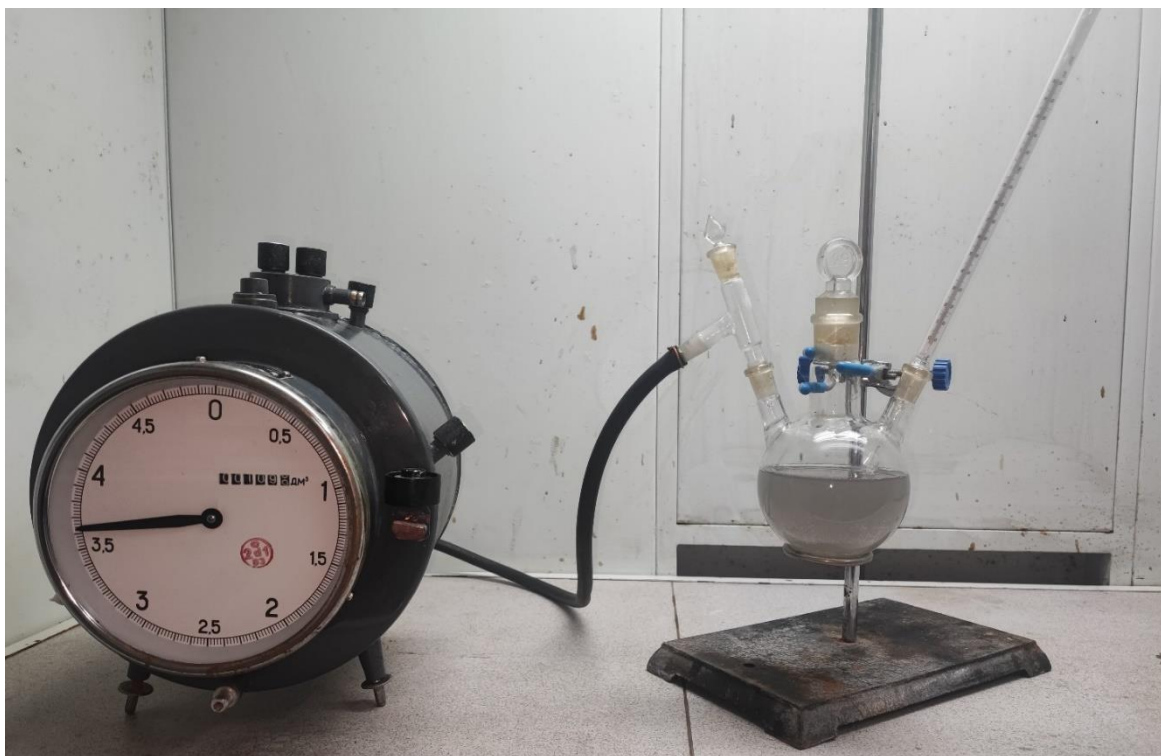
Рисунок 2 –Фотоснимок установки для регистрации объема выделившегося газа и измерения температуры
